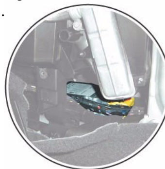
Steuergerät für Airbag J234, unter der Mittelkonsole, auf dem Tunnel vorne
