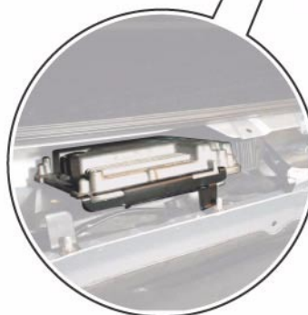
Steuergerät für Motronic J220, unter der Wasserkastenabdeckung
