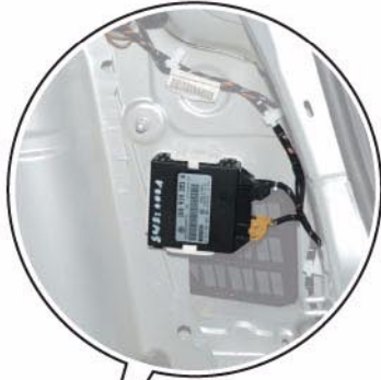
Steuergerät für Einparkhilfe J446, im Seitenteil hinten rechts
