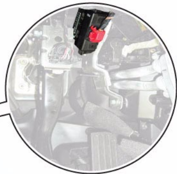
Diagnose-Interface für Datenbus J533, unter der Schalttafel, oberhalb des Gaspedals
