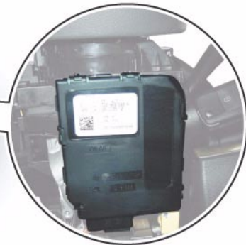
Steuergerät für Lenksäulenelektronik J527, unter dem Lenkstockschalter
