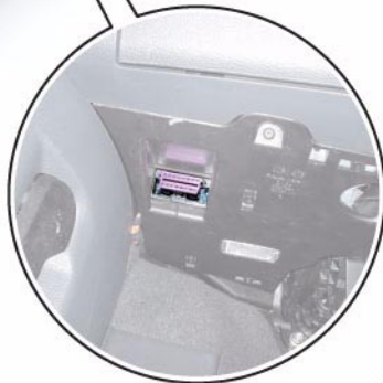
Steckverbindung 16fach, Diagnoseanschluss T16, unter der Schalttafel links
