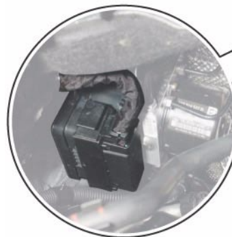
Steuergerät für ABS mit EDS J104, an der Spritzwand im Motorraum rechts
