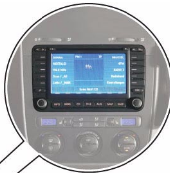
Steuergerät mit Anzeigeeinheit für Radio und Navigation J503 oder Radio R, in der Mittelkonsole
